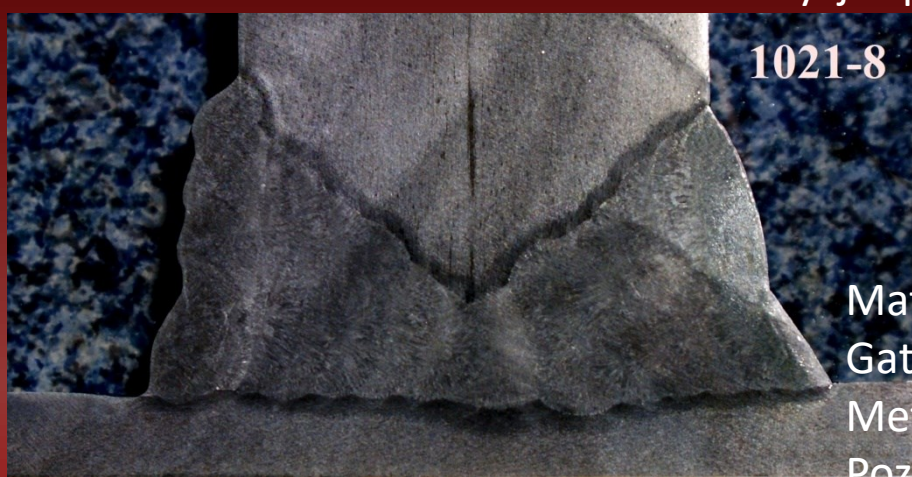
Materiał: blacha #50 Gatunek: S355J2+N Metoda spawania: 135 Pozycja spawania: PC
